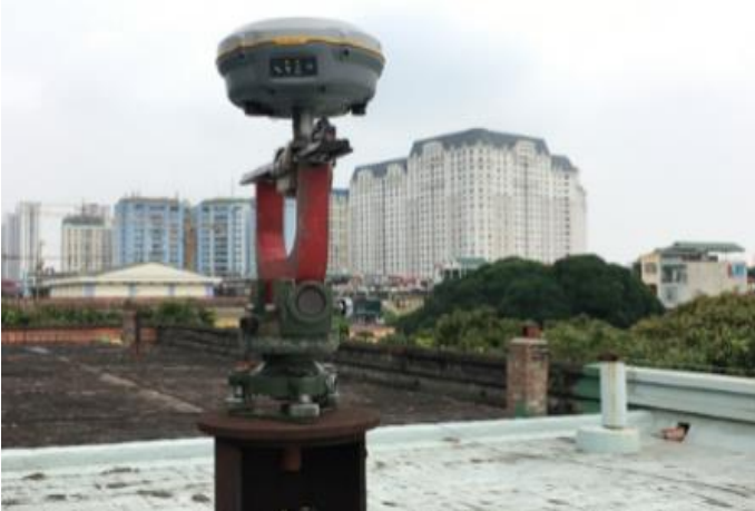
Hình 2.7. Thiết bị kiểm định độ chính xác công nghệ GNSS - RTK
