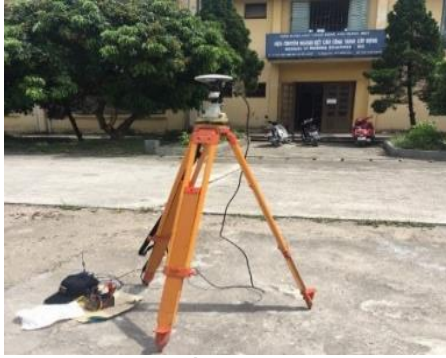
Hình 4.9. Máy GNSS-RTK - Gắn gương 360° và hệ thu phát sóng 3G
